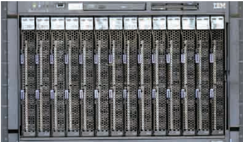
El ordenador Magerit está formado por cerca de 2.800 CPU. Para lograr conectar un número tan elevado de procesadores, éstos se organizan en "blades" o cuchillas. El bloque de 14 cuchillas de la imagen contiene 28 procesadores.
